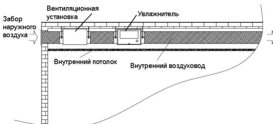
Принципиальная схема установки и использования увлажнителя воздуха канального типа MINI-D и вентиляционной установки.
